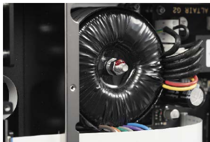
Zasilacz jest liniowy, z transformatorem toroidalnym i rozbudowanymi układami filtrującymi.
