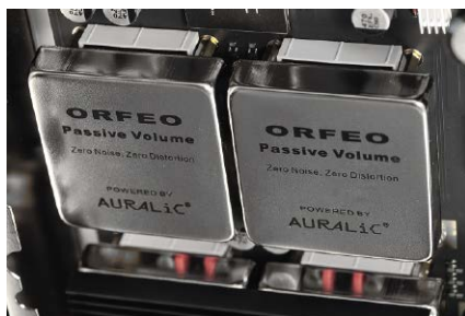
Regulator głośności zaprojektował Auralic, bez użycia gotowych układów scalonych, a tylko przekaźników i rezystorów.
